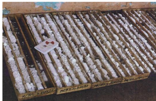
Caisses de carottes contenant des échantillons de sondages prélevés à Pascal-Icart
